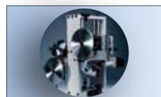
Il gruppo raschia bordo arrotonda il bordo a seconda del raggio richiesto, lavora con due grossi copiatori nesting che permettono di lavorare ad alte velocità. Il gruppo dispone di due posizionamenti pneumatici.
